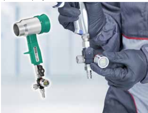
SATA adam 2 U – sušící pistole SATA dry jet, ale také pistole jiných výrobců se dají "digitalizovat"
